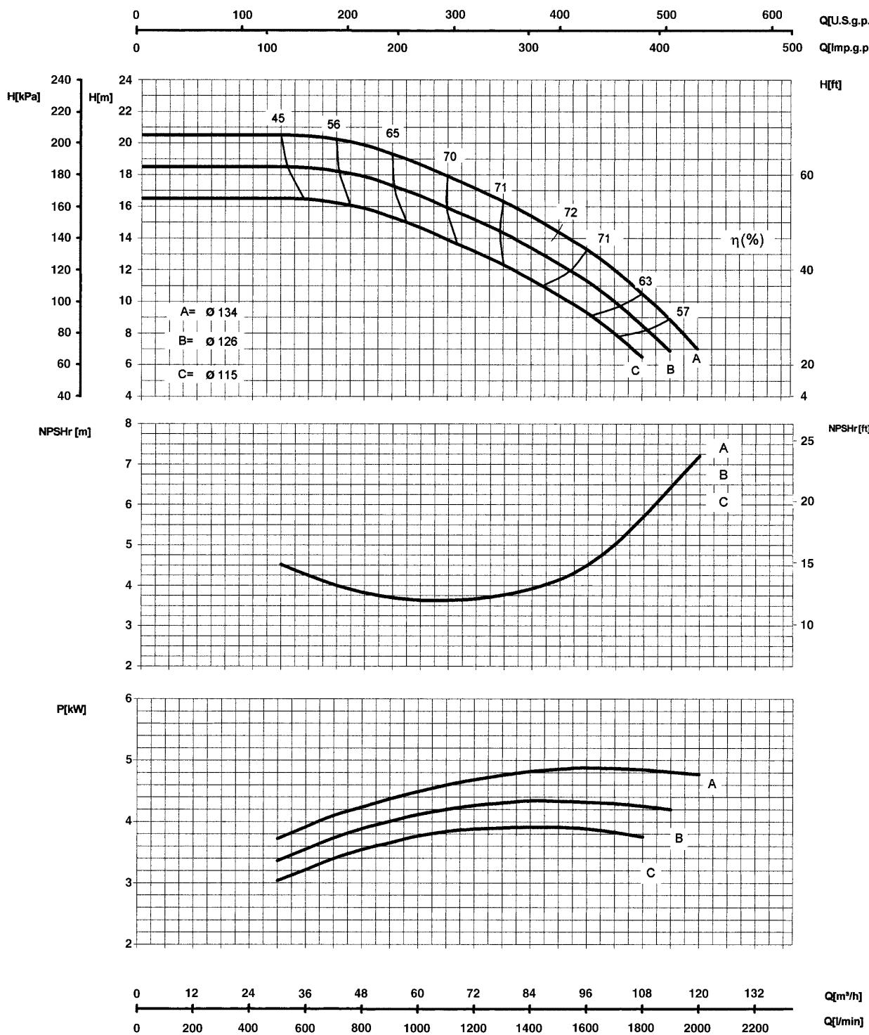
BP8/B La potenza nominale ha un coefficiente di sovraccarico del 10% • BP8/B The nominal power has an overload coefficient of 10%
