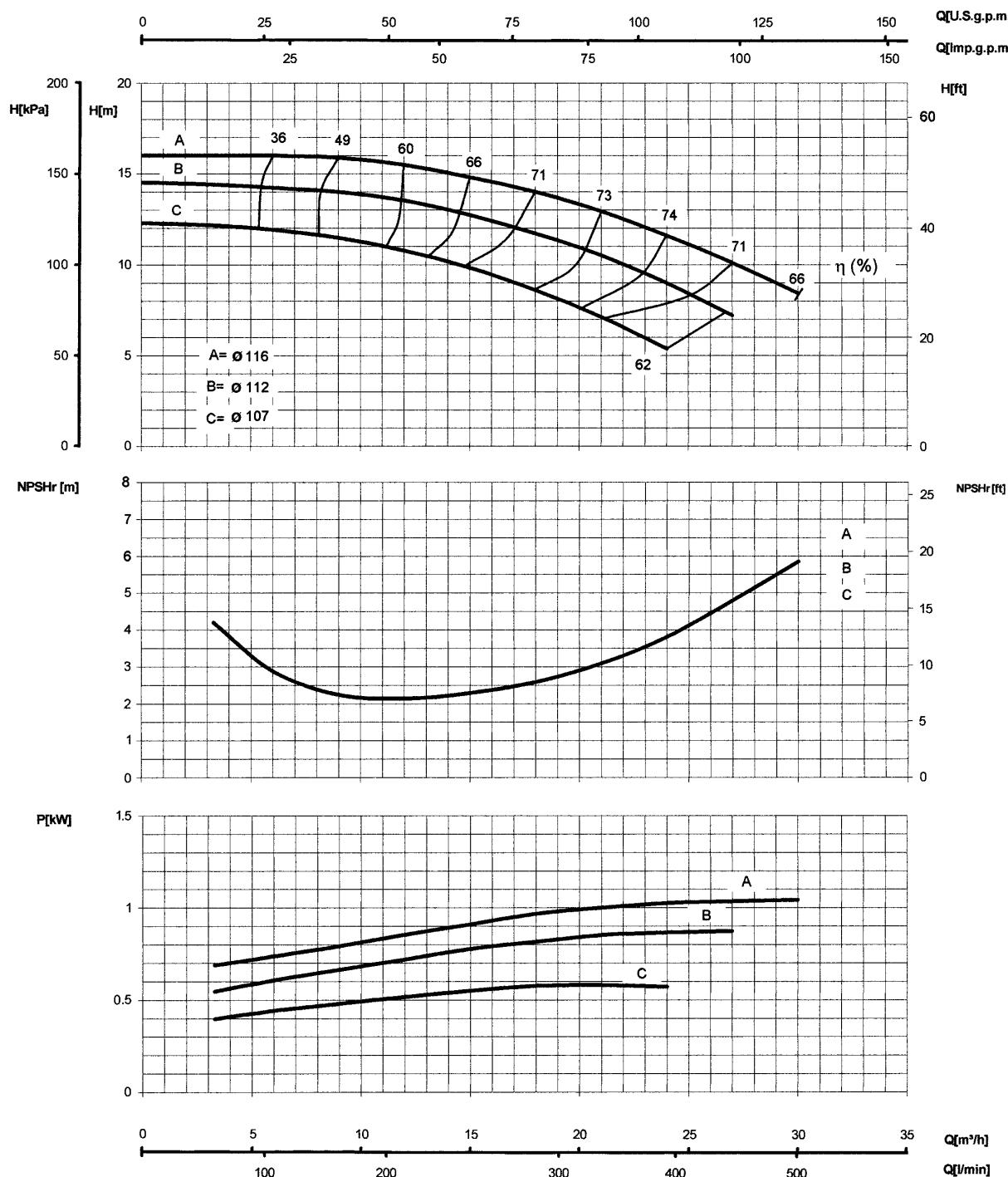
BP6/A La potenza nominale ha un coefficiente di sovraccarico del 25% • BP6/A The nominal power has an overload coefficient of 25%
